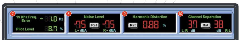
**7** Control permanente de la frecuencia de la señal piloto de 19 khz, así como de su nivel relativo.
