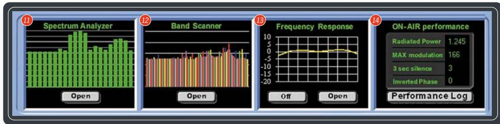
**11** El **Spectrum Analyzer** permite conocer si el ancho de banda de la Radio es el correcto y si está cumpliendo con las Regulaciones y Normas vigentes, la **curva de Bandwidth** expresa esta información en función del Porcentaje de Modulación.
